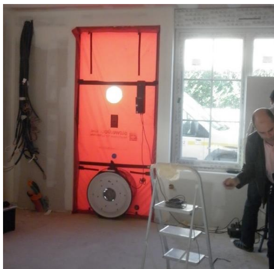
Photo : Porte soufflante lors du test d'étanchéité intermédiaire sur la rénovation C1 - 2 « HOULGATE »
