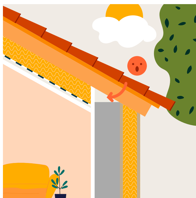
Étape 2 Isolation des murs par l'extérieur
