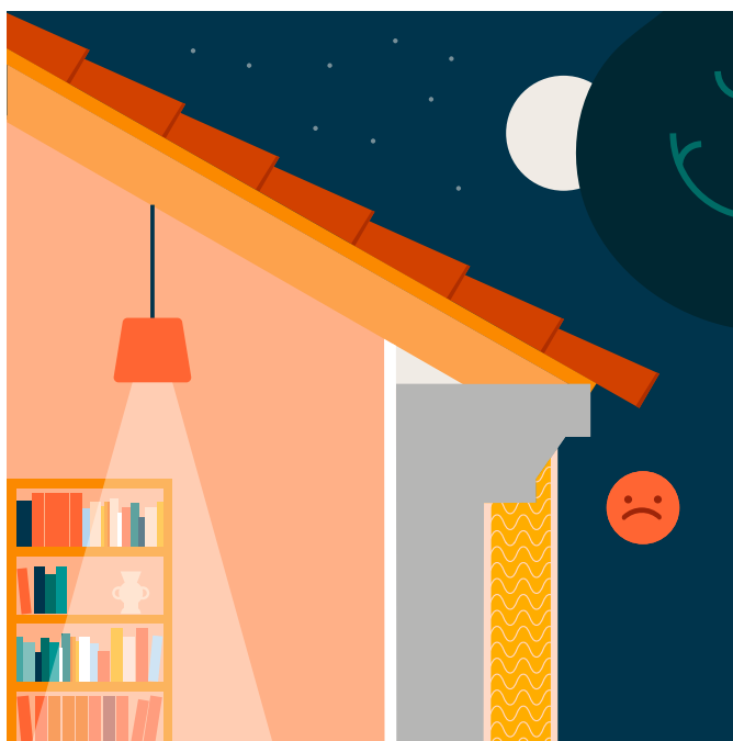
Étape 1 Isolation des murs par l'extérieur
