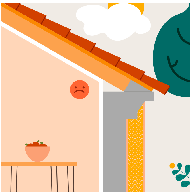
Étape 1 Isolation des murs par l'extérieur
