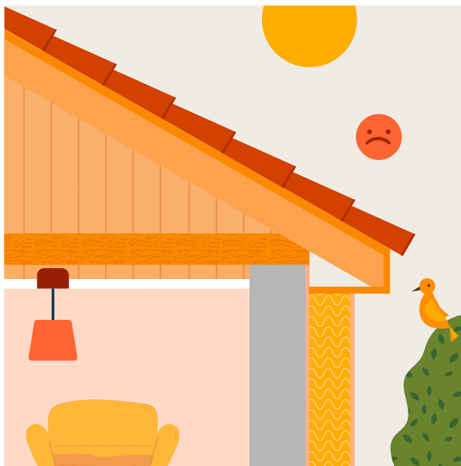
Étape 1 Isolation des murs par l'extérieur
