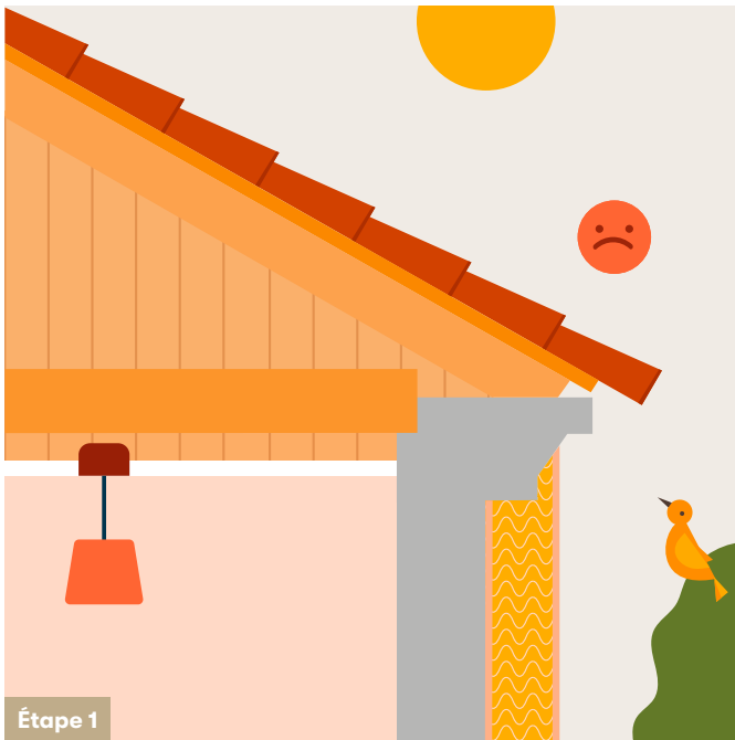
Isolation des murs par l'extérieur avec débord de toit maçonné
