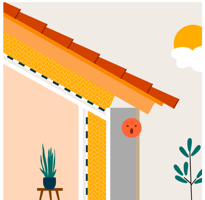
Étape 2 Isolation des murs par l'intérieur
